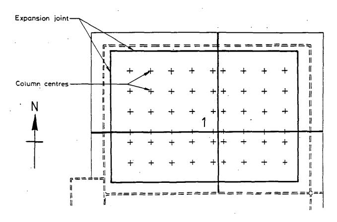
TYPICAL POSITION OF EXPANSION JOINTS IN TANKS 1 & 2
